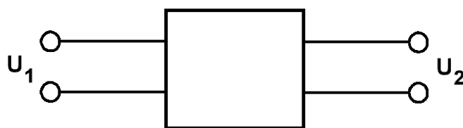
Рис. 1.1. Схематическое изображение линейного четырехполюсника
